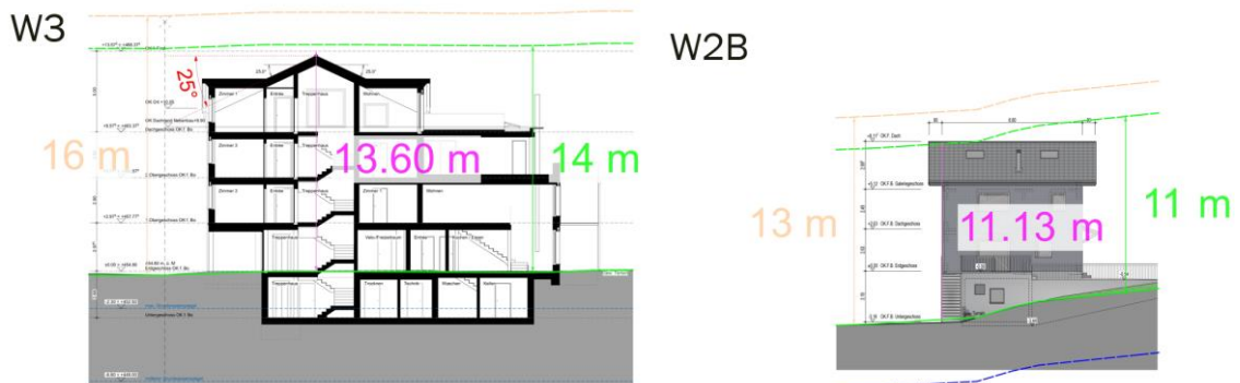
Abbildung 11: Beispiel Überprüfung Gesamthöhe
